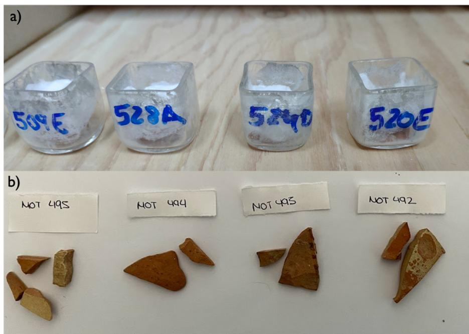
**Figura 3.3.** a) Cubos de cuarzo con muestras cerámicas en su interior preparados para la realización de los experimentos clásicos de Thellier. b) Fragmentos cerámicos seleccionados para los experimentos de paleointensidad.
